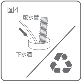
图4：废水口接通红色 2分PE管直接排到下水道，并固定防止脱出造成漏水。
